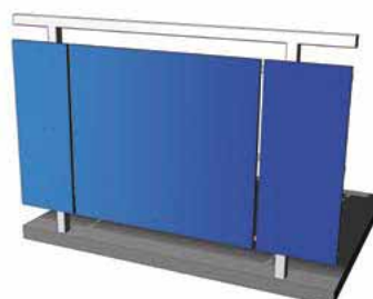
Rys. Mocowanie do słupków - płyty przelotowa.
