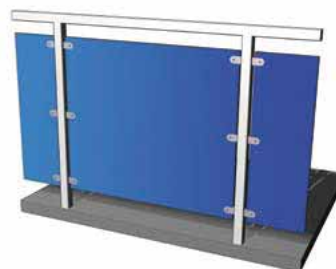
Rys. Mocowanie do słupków za pomocą łączników lub uchwytów zaciskowych.
