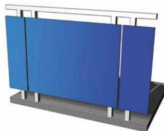
Rys. Mocowanie do słupków w sekcjach.
