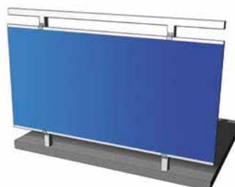
Rys. Mocowanie do słupków w profile typu Z
